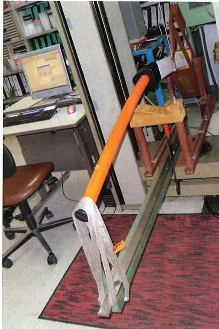
Abbildung 7: Bestimmung des maximalen Biegemoments bei Normklima
