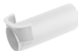
**HWD/RST**, Rohrstopfen, halogenfrei: luftdichter Verschlussstopfen aus TPE, mit Durchstoßmembran zum Durchführen von Kabel und Leitungen, zum Abdichten von Wellrohren in Gerätedosen oder an Leitungsauslässen
