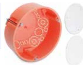
**HWAK**, Hohlwand-Abzweigkasten: orange (RAL 2004), erforderliche Fräslöcher 4x Ø 35 mm, 8 Rohreinführungen Ø 20 mm, mit Führungsnut für Trennwände
