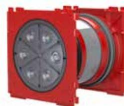
**HSI150 DFK**, Kunststoffflansch zum nachträglichen Andübeln über Kernbohrungen oder Anschrauben an Gehäusen (Containern); gas- und wasserdicht bis 2,5 bar, für alle HSI150 Systemdeckel (EGO MS805 Dichtmasse für Montage notwendig)
