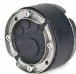
**HSD150 SSG 1x70-112 b40 A2/EPDM55**, Dichtung mit Segmentringen, für Dimensionen zwischen 70 und 112 mm, inkl. Blindstopfen, geteilt, stufenlos; Kernbohrung 150 mm, Dichtbreite 40 mm, 2,5 bar druckdicht, mit Drehmomentkontrolle und aus rostfreiem Edelstahl
