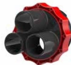
**HSI150**, Systemdeckel; Kabelabdichtung für Dichtpackung und Kunststoffflansch HSI150 mit Kaltschrumpftechnik (KS) bzw. Warmschrumpftechnik (WS), Bajonettssystem, gas- und wasserdicht bis 2,5 bar, unbelegte Systemdeckelstutzen können mit Verschlussstopfen (VS) verschlossen werden
