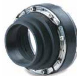
**HSD250 SSG 1x159-211 b40 A2/EPDM55**, Dichtung mit Segmentringen, für Dimensionen zwischen 159 und 211 mm, ohne Blindstopfen, geteilt, stufenlos; Kernbohrung 250 mm, Dichtbreite 40 mm, 2,5 bar druckdicht, mit Drehmomentkontrolle und aus rostfreiem Edelstahl
