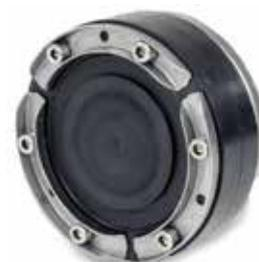
**HSD200 SSG 1x110-162 b40 A2/EPDM55**, Dichtung mit Segmentringen, für Dimensionen zwischen 110 und 162 mm, inkl. Verschlussdeckel, geteilt, stufenlos; Kernbohrung 200 mm, Dichtbreite 40 mm, 2,5 bar druckdicht, mit Drehmomentkontrolle und aus rostfreiem Edelstahl
