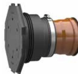
**AT110**, Anschlussstrichter mit integriertem Trittschutzeinsatz zum Einbetonieren in die Bodenplatte für die optimale Abdichtung zum KG-Rohr, zum Ausgleich eines Versatzes (nach dem Betonieren) zwischen Fallrohr und Bodenablauf in jede Richtung
