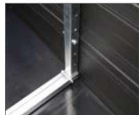
Nach Entfernen der 4 Clips (per Hand oder mit Schraubenzieher odgl.) im Bereich der zu teilenden Elementfuge wird das ROM-BOX Oberteil vom ROM-BOX Unterteil per Hand abgehoben. Das ROM-BOX Unterteil wird unter die vorhandenen Leerrohre oder Kabel eingebracht und das ROM-BOX Oberteil wieder auf das ROM-BOX Unterteil aufgesetzt. Nach werkzeuglosem Einsetzen der Clips ist die ROM-BOX wieder fixiert und komplett.
