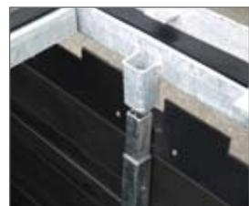
Bei Seitenlängen der Kabelschächte ab 900 mm werden U-Rahmen (bestehend aus einem oder mehreren horizontalen und zwei vertikalen, teleskopierbaren Profilen aus feuerverzinktem Stahl) verwendet.
