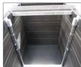
Die Vertikalleisten sind herauszunehmen bevor das Unterteil eingebracht wird und anschließend wieder einzusetzen.
