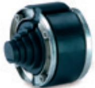
**HSD 100-SSG 25-63**, Dichtung mit Segmentringen, für 5 verschiedene Dimensionen zwischen 25 und 63mm, inkl. Blindstopfen, geteilt; Kernbohrung 100mm, Dichtbreite 40mm, 1bar druckdicht, mit Drehmomentkontrolle und aus rostfreiem Edelstahl.
