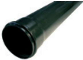
**KKR-PVC**, Kabelkanalrohre aus PVC, mit Steckmuffe und eingelegtem Lippendichtring, in Stangen zu 5m, schwarz, Außendurchmesser nach ÖNORM E 6510, gemäß ÖVE/ÖNORM EN 61386-24
