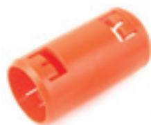
**KM Turbo Krallenmuffe**, flammgeschützt (ausgenommen orange Ausführung), aus PE, zur wasserdichten und zugfesten Verbindung von Rohren im Zuge der Betonverlegung, IP 40. Orange Ausführung halogenfrei. gemäß ÖVE/ÖNORM EN 61386
