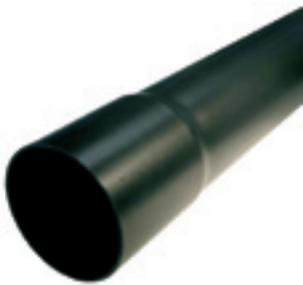
**KSR**, Kabelschutzrohre aus PVC-hart (PVC-U), einseitig aufgemufft, in Stangen zu 3m und 6m, gemäß ÖVE/ÖNORM EN 61386-24, **normale Ausführung; Druckfestigkeit >450N**
