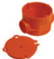
Für Geräte-Schraub- und Spreizbefestigung, Schraubenabstand 60mm, Geräteeinbauöffnung 60mm, kombinierbar im Normabstand von 71mm, Einbauhöhe 49mm.
