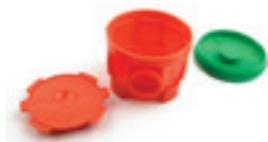
Für Geräte-Schraubbefestigung, Schraubenabstand 67mm, für Perilex-Einsätze 16A, Einbauhöhe 71mm.
