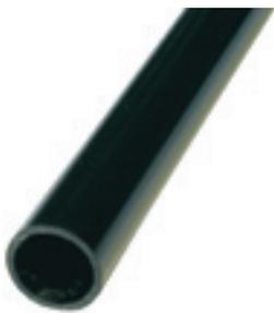
**KSXS und KSX**, Kabelschutzrohre aus PE, ohne Muffe, in Stangen zu 6m und in Ringen zu 100m bzw. 50m, gemäß ÖVE/ÖNORM EN 61386-24
