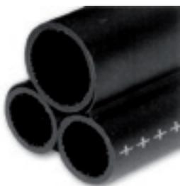
**MBR, Mehrfachbelegungsrohre aus PE** (außen glatt, innen längsgerieft), ohne Muffe, auf E 28 Trommeln zu 600m bzw. 900m, schwarz gemäß TS 0056/00:2007-07
