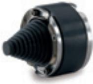
**HSD 100-SSG 18-65-SL**, Dichtung mit Segmentringen, für Dimensionen zwischen 18 und 65mm, inkl. Blindstopfen, geteilt, stufenlos; Kernbohrung 100mm, Dichtbreite 40mm, 1bar druckdicht, mit Drehmomentkontrolle und aus rostfreiem Edelstahl.
