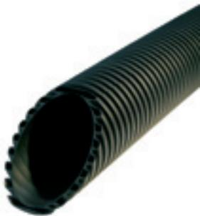
**FXKVS und FXKVR**, Kabelschutzrohre aus PE, inkl. Muffe, in Stangen zu 6m und in Ringen zu 50m bzw. 25m, Ringware inkl. kunststoffummanteltem Metalleinziehdraht Ø 0,8mm; gemäß ÖVE/ÖNORM EN 61386-24
