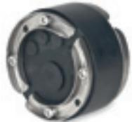
**HSD 100-EWD**, Dichtung mit Segmentringen, für 5 verschiedene Dimensionen zwischen 7 und 44mm, inkl. Blindstopfen; Kernbohrung 100mm, Dichtbreite 40mm, 1bar druckdicht, mit Drehmomentkontrolle und aus rostfreiem Edelstahl.
