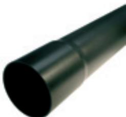
**BR**, Baurohre aus PVC-hart (PVC-U), einseitig aufgemufft, in Stangen zu 6m, gemäß ÖVE/ÖNORM EN 61386-24, **Druckfestigkeit >250N**
