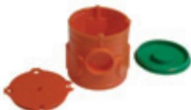
Für Geräte-Schraub- und Spreizbefestigung und als Abzweigdose mit reichlichem Klemmraum, Schraubenabstand 60mm, Geräteeinbauöffnung 60mm, kombinierbar im Normabstand von 71mm, Einbauhöhe 74mm.
