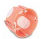
**HWDW 65,** Hohlwand-Geräte-Abzweigdose, luftdicht: orange (RAL 2004), Schraubennormabstand 60 mm, erforderliche Einbauöffnung Ø 68 mm, äußerer Dosenrand Ø 71 mm, für Plattenstärke 7 bis 35 mm, 4 Rohreinführungen Ø 20 mm, 2 Rohreinführungen Ø 25 mm, 4 Kabeleinführungen
