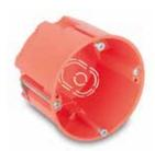
**HWAD 65, Hohlwand-Geräte-Abzweigdose tief:** orange (RAL 2004), Schraubennormabstand 60 mm, erforderliche Einbauöffnung Ø 68 mm, äußerer Dosenrand Ø 71 mm, für Plattenstärke 7 bis 35 mm, 4 Rohreinführungen Ø 20 mm, 2 Rohreinführungen Ø 25 mm, 4 Kabeleinführungen
