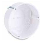
**HWAD 120 HFT, Hohlwand-Abzweigdose, halogenfrei:** weiß (RAL 9010), erforderliche Einbauöffnung Ø 121 mm, äußerer Dosenrand Ø 126 mm, für Plattenstärke 7 bis 35 mm, 5 Rohreinführungen Ø 20 mm, 4 Rohreinführungen Ø 25 mm, 16 Kabeleinführungen
