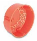
**HWAD 120, Hohlwand-Abzweigdose:** orange (RAL 2004), erforderliche Einbauöffnung Ø 121 mm, äußerer Dosenrand Ø 126 mm, für Plattenstärke 7 bis 35 mm, 5 Rohreinführungen Ø 20 mm, 4 Rohreinführungen Ø 25 mm, 16 Kabeleinführungen
