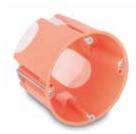
**HWADW 65,** Hohlwand-Geräte-Abzweigdose, luftdicht, tief: orange (RAL 2004), Schraubennormabstand 60 mm, erforderliche Einbauöffnung Ø 68 mm, äußerer Dosenrand Ø 71 mm, für Plattenstärke 7 bis 35 mm, 4 Rohreinführungen Ø 20 mm, 2 Rohreinführungen Ø 25 mm, 4 Kabeleinführungen
