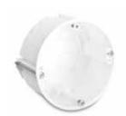
HWDW 65 HFT, Hohlwand-Geräte-Abzweigdose, halogenfrei, luftdicht: weiß (RAL 9010), Schraubennormabstand 60 mm, erforderliche Einbauöffnung Ø 68 mm, äußerer Dosenrand Ø 71 mm, für Plattenstärke 7 bis 35 mm, 4 Rohreinführungen Ø 20 mm, 2 Rohreinführungen Ø 25 mm, 4 Kabeleinführungen
