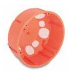
**HWADW 120, Hohlwand-Abzweigdose, luftdicht:** orange (RAL 2004), erforderliche Einbauöffnung Ø 121 mm, äußerer Dosenrand Ø 126 mm, Plattenstärke 7 bis 35 mm, 3 Rohreinführungen Ø 20 mm, 3 Rohreinführungen Ø 25 mm, 3 Kabeleinführungen
