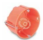
**HWD 65, Hohlwand-Geräte-Abzweigdose:** orange (RAL 2004), Schraubennormabstand 60 mm, erforderliche Einbauöffnung Ø 68 mm, äußerer Dosenrand Ø 71 mm, für Plattenstärke 7 bis 35 mm, 4 Rohreinführungen Ø 20 mm, 2 Rohreinführungen Ø 25 mm, 4 Kabeleinführungen
