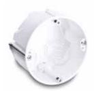
**HWD 65 HFT, Hohlwand-Geräte-Abzweigdose, halogenfrei:** weiß (RAL 9010), Schraubennormabstand 60 mm, erforderliche Einbauöffnung Ø 68 mm, äußerer Dosenrand Ø 71 mm, für Plattenstärke 7 bis 35 mm, 4 Rohreinführungen Ø 20 mm, 2 Rohreinführungen Ø 25 mm, 4 Kabeleinführungen
