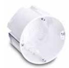
**HWAD 65 HFT, Hohlwand-Geräte-Abzweigdose, halogenfrei, tief:** weiß (RAL 9010), Schraubennormabstand 60 mm, erforderliche Einbauöffnung Ø 68 mm, äußerer Dosenrand Ø 71 mm, für Plattenstärke 7 bis 35 mm, 4 Rohreinführungen Ø 20 mm, 2 Rohreinführungen Ø 25 mm, 4 Kabeleinführungen
